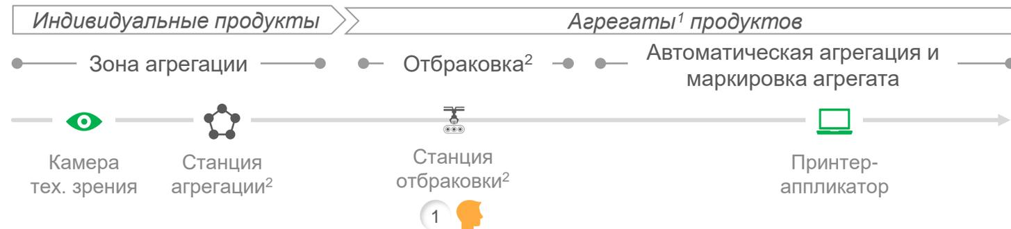
1 Если на этапе агрегации камера тех. зрения зафиксировала проблемы с индивидуальным DM кодом или отклонением кол-ва продуктов в упаковке от целевого, индивидуальная продукция отправляется повторно на сериализацию (в случае проблемы с кодом) или в зону агрегации
